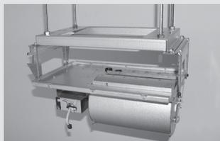
L'outil de levage a été retiré et il y a assez d'espace pour raccorder l'alimentation électrique et les câbles de signal.
