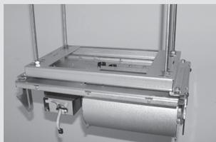
Enfin, le générateur de brouillard doit être poussé tout contre la plaque métallique et les vis doivent être serrées.
