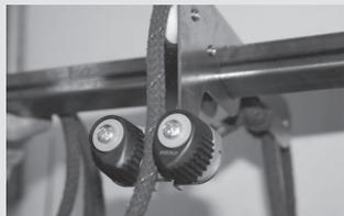
Les poulies autobloquantes de l'outil de levage permettent que l'installation soit faite par une seule personne.
